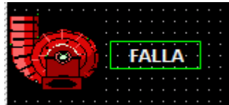
8.2.6 Ejemplo visual del estado del motor, en este ejemplo se interpreta que la bomba está en falla
