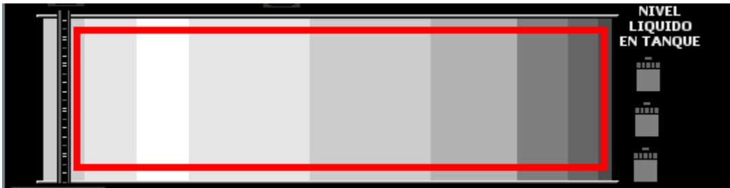
8.2.3 Vista del grafico scada de cisterna en vacío. El cual el recuadro rojo indica alerta de Cisterna está vacía.
