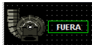
8.2.5. ejemplo visual del estado del motor, en este ejemplo se interpreta que la bomba esta fuera por medio del selector.
