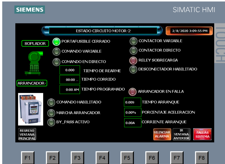
Figura 7.0 vista de estado del sistema. Muestra el estado del motor activado, modo de operación fallas registradas, incluyendo estado básico del arrancador.
