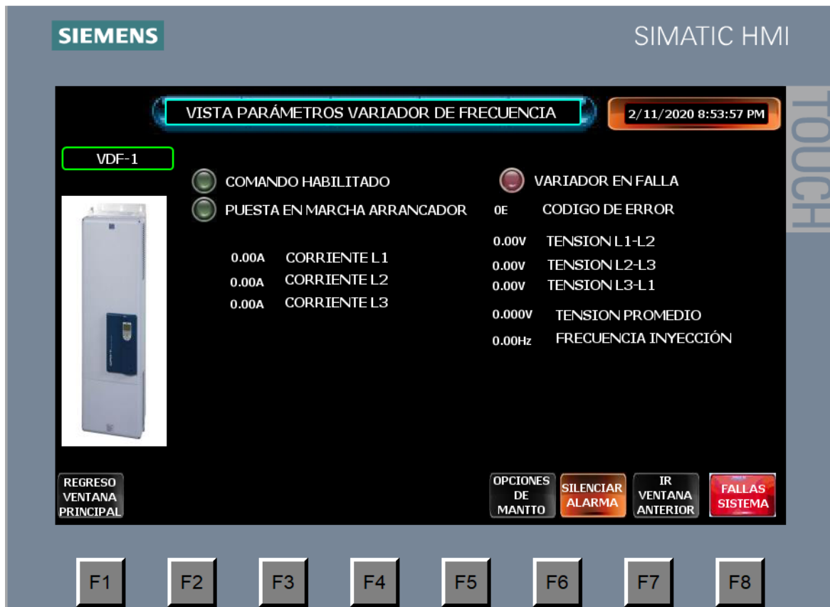
Figura 7.1.0 Vista de los parámetros energéticos extraídos del VDF vía comunicación profinet
