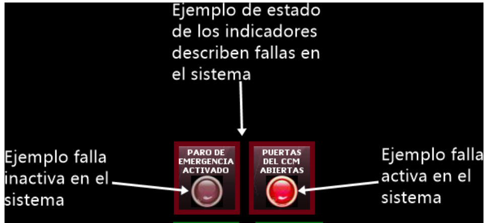
Figura 1.2, Descripción de los indicadores dentro de la pantalla touch descripción de los indicadores de falla en el sistema.
