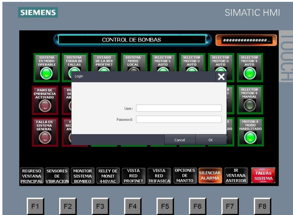
Figura 4.1.2 Vista de acceso por medio de credenciales de Usuario, ventana protegida a usuario general.
