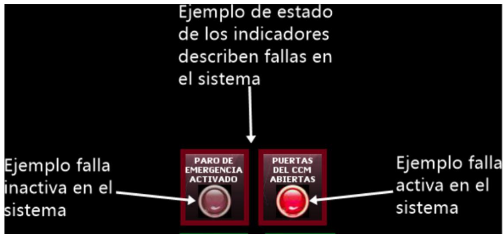
Figura 1.2 Descripción de los indicadores dentro de la pantalla táctil, descripción de los indicadores de falla en el sistema
