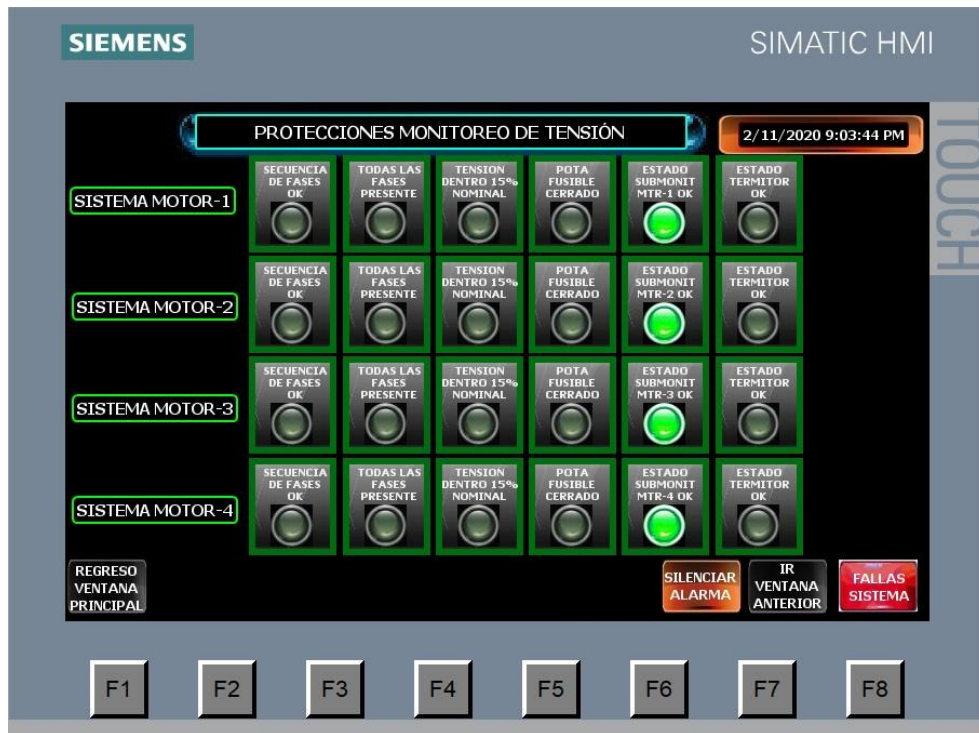
Figura 7.2 Visualización de los dispositivos de monitoreo de red eléctrica, mostrando todos los circuitos de potencia.
